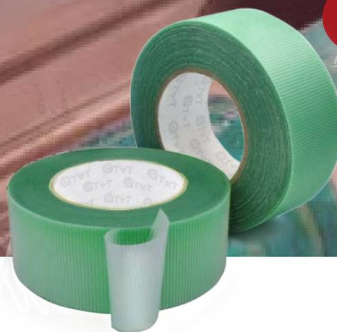
Cinta de doble cara con soporte rígido de PVC de espesor 200 µm diseñada para el montaje de fotopolímeros, compuesta por un soporte de PVC rígido transparente recubierto en ambas caras por un adhesivo de caucho solvente y protegido por un liner de PVC gofrado verde.
